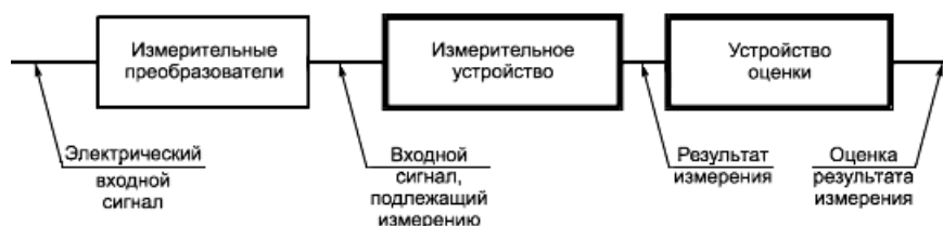
Рисунок 1 - Полная измерительная цепь
