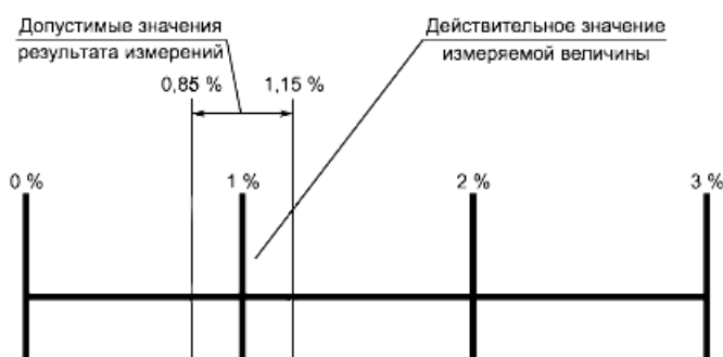
Рисунок 5 - Пример неопределенности измерений несимметрии напряжений
